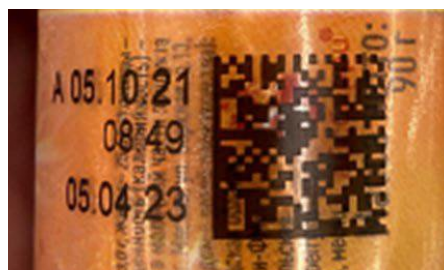
Печать кода маркировки на бликующей/светоотражающей поверхности
