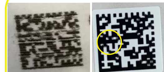
Смазывание кода маркировки или его отдельных элементов
