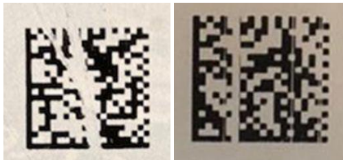
Нарушение целостности КМ*
