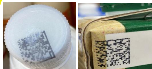
Смещение кода маркировки при печати
